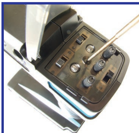
Maintenez enfoncé le bouton "Blind" avant de mettre sous tension votre radio.
