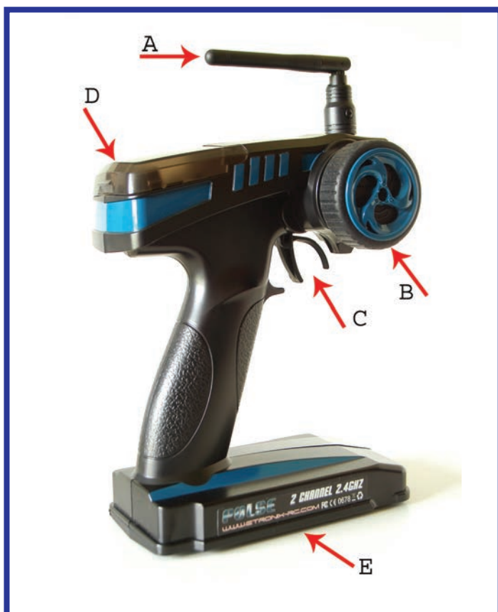
L'antenne se plie pour un meilleur stockage. Mais elle se déplie et est positionnable pour maximiser la portée de la radio
